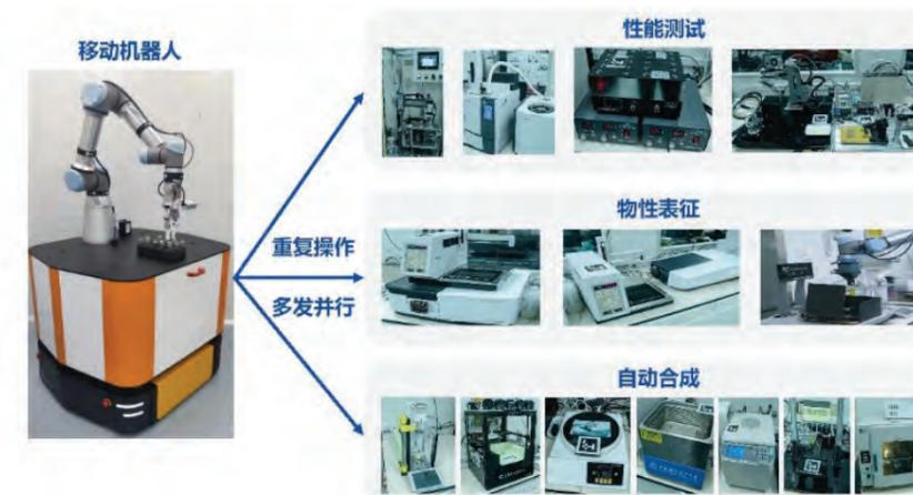
图2. 移动机器人和智能工作站完成高通量合成、表征、测试的化学实验全流程
